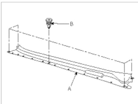
3. 拧下2个螺栓和一个螺母,拆下挡风玻璃雨刮器电机和连杆总成。从雨刮器电机与连杆总成位置分离雨刮器电机连接器(A)和挡风玻璃除霜器连接器(B)。
