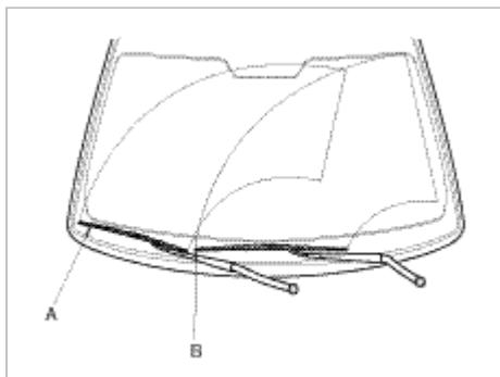
2. 将喷水器喷嘴调整在指定喷射位置。
